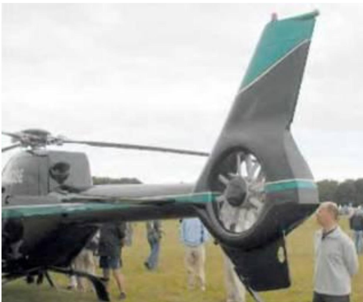
У такого типа вертолета большая скорость вращения, шумность и уровень вибраций снижены, затраты мощности при полете более низкие, однако они обладают большой массой, дорого стоят и наделены высокими требованиями к тяге двигателя.
