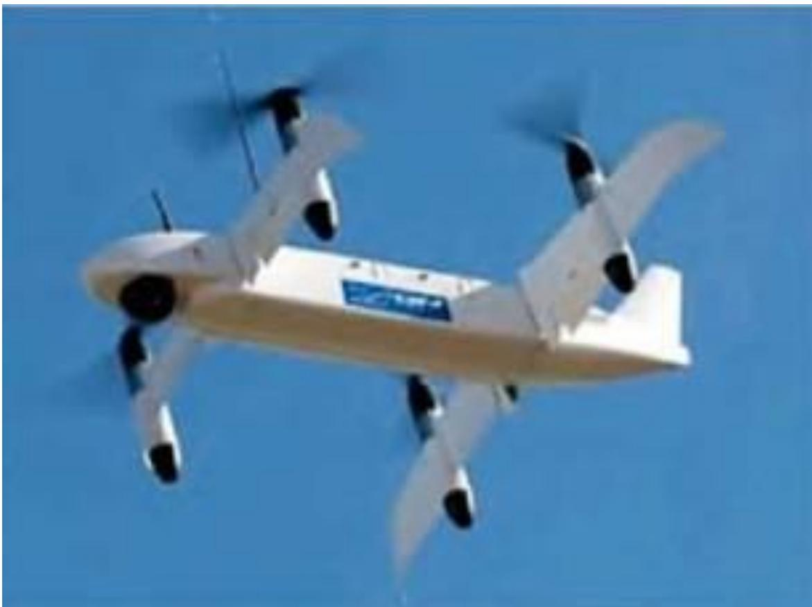
**Рис.24. Конвертоплан со свободным крылом – Freewing**
