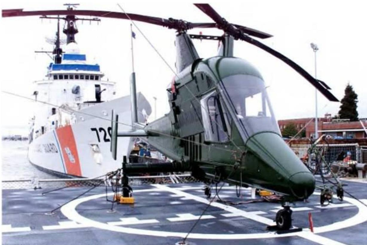
Такие вертолеты отличает боковое расположение несущих винтов по бокам фюзеляжа и наклонное расположение оси наружу. Габариты вертолеты сравнительно невелики, но много недостатков – и необходимость синхронизации вращения винтов, и сложная система трансмиссии, и большой уровень вибраций, и возникновение продольного момента, усложняющего балансировку вертолета. При этом Вертолет хорошо приспособлен для вертикального подъема грузов.
