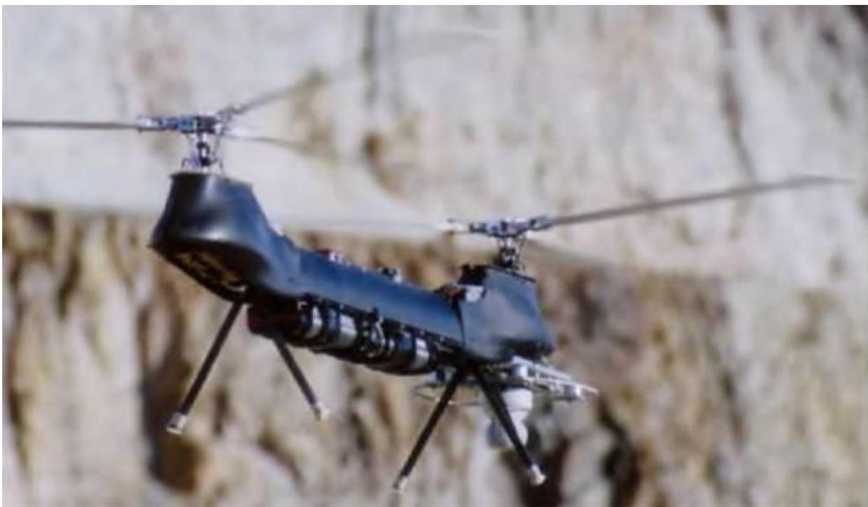
Несущие винты располагаются с перекрытием, причем задний винт имеет превышение, чтобы уменьшить вредное влияние на него потока от переднего винта. Несомненное достоинство – большой объем грузовой кабины, но система трансмиссии сложна, необходимо синхронизировать вращение несущих винтов, большие индуктивные потери при горизонтальном полете и переменные нагрузки на несущих винтах, а также сложная посадка при авторотации.
