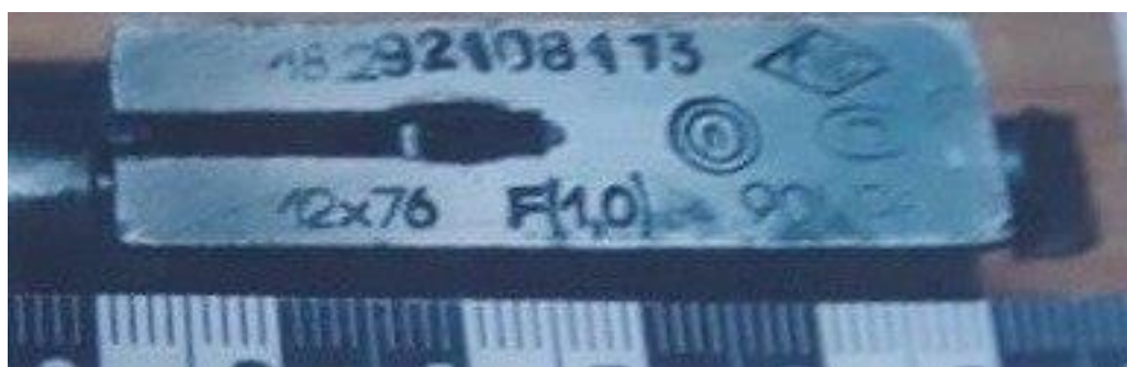
Рисунок 2.2.2 - маркировочные обозначения на нижней поверхности подствольного крюка представленного ружья.
