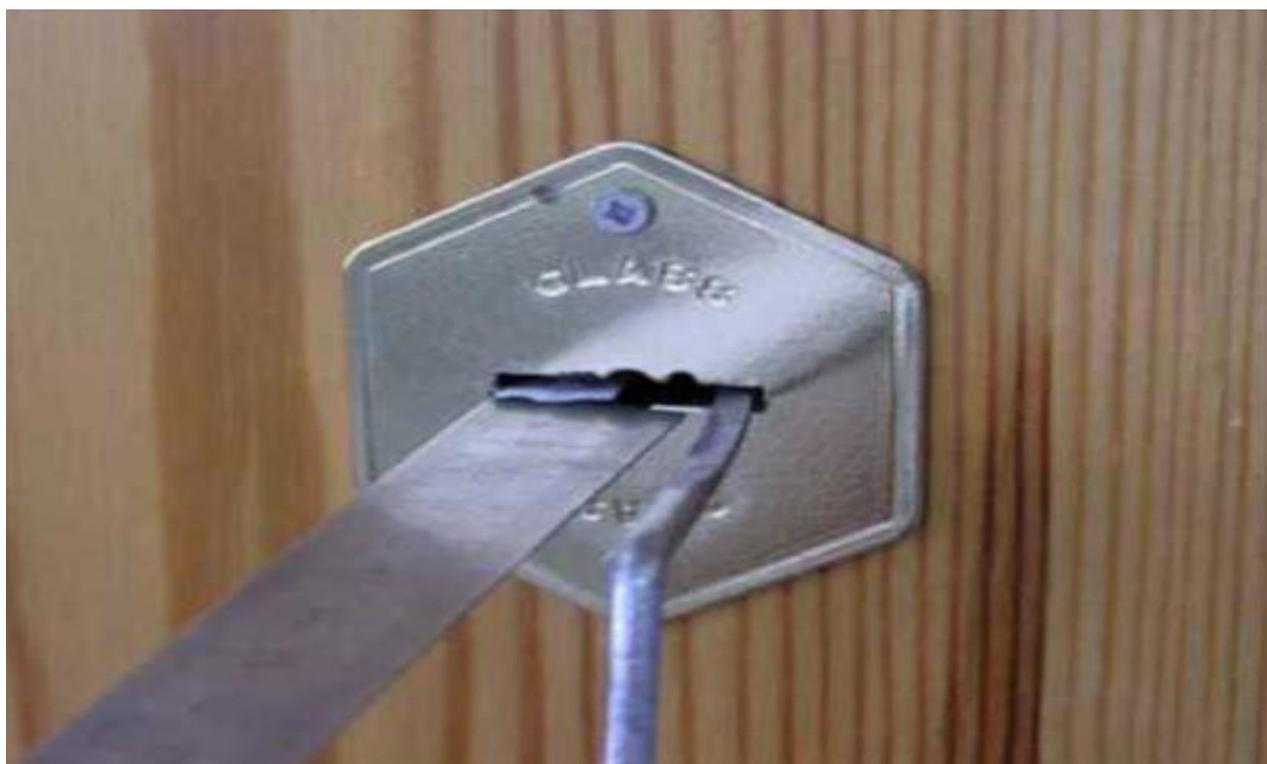
*Рис. 22. Процесс снятия оттиска.*
