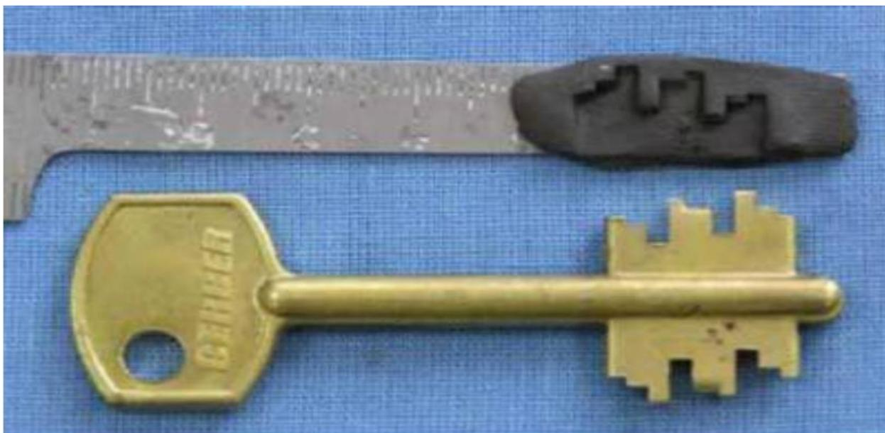
Рис. 21. А) Инструмент для снятия оттиска ключа. Б) Оттиск ключа.
