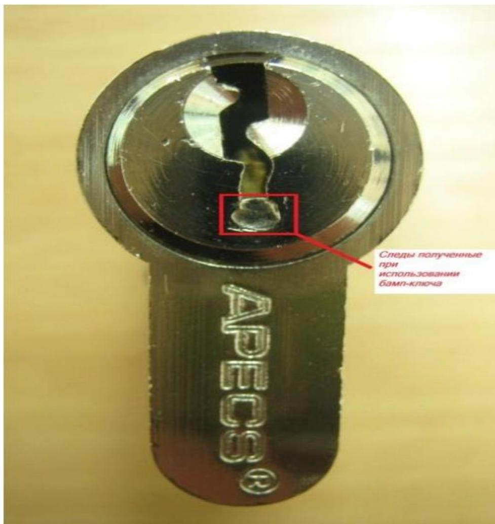
Рис. 33. Выдавленный след на торцевой части скважины, характерные для бамп-метода.
