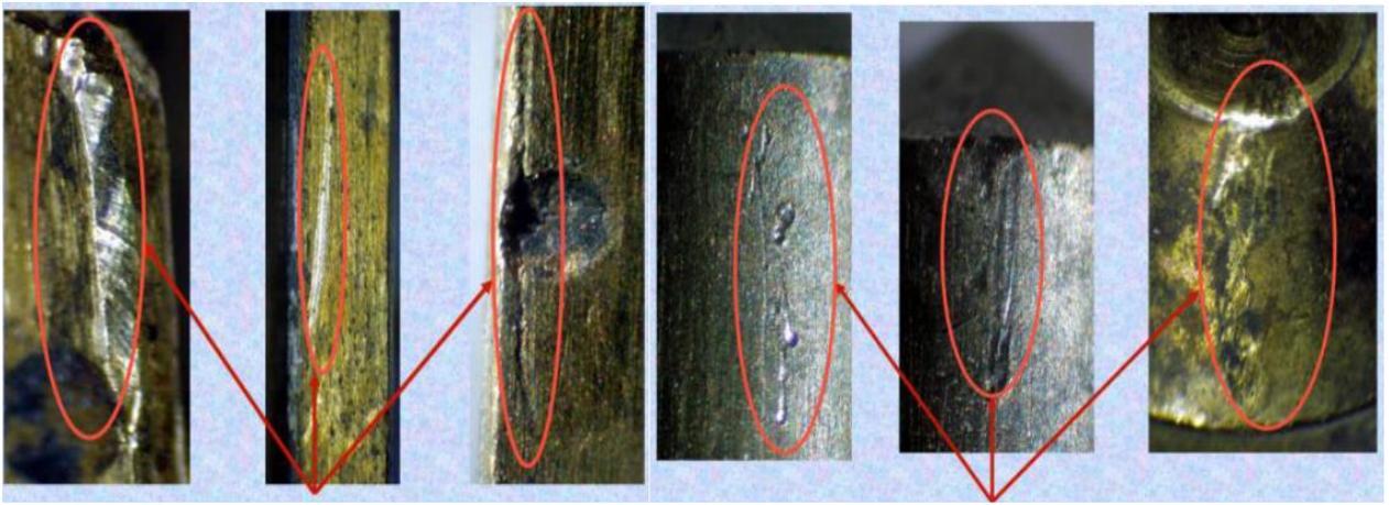
*Рис. 32* характерные следы воздействия отмычек.
