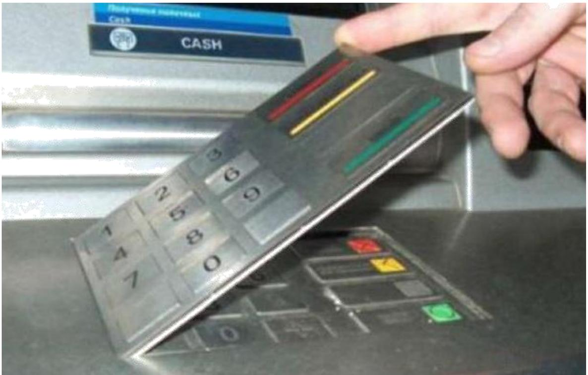
Рисунок 3 - Кейлогер в виде накладки на панели ввода пин-кода.
