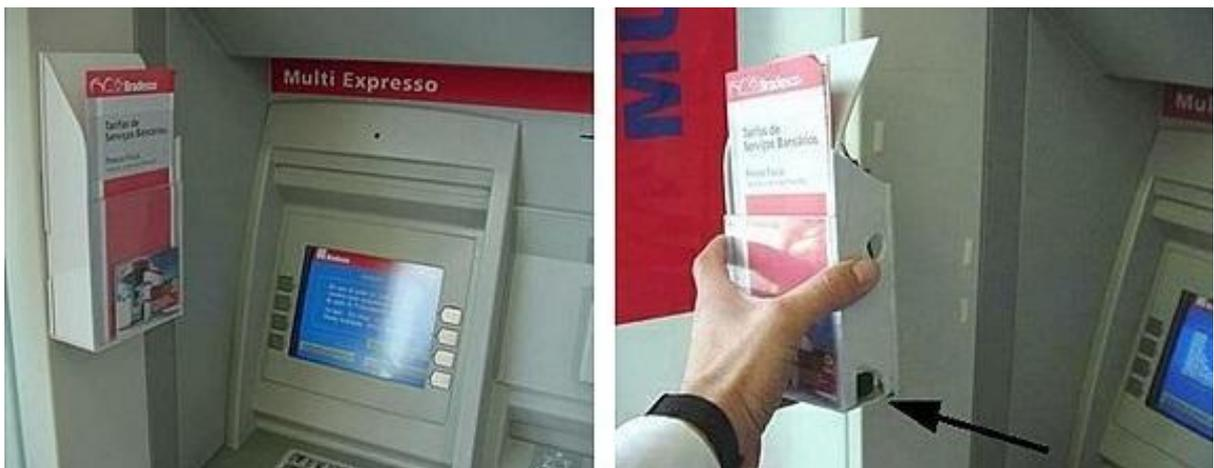
Рисунок 2 - Замаскированная камера, фиксирующая вводимый пин-код.
