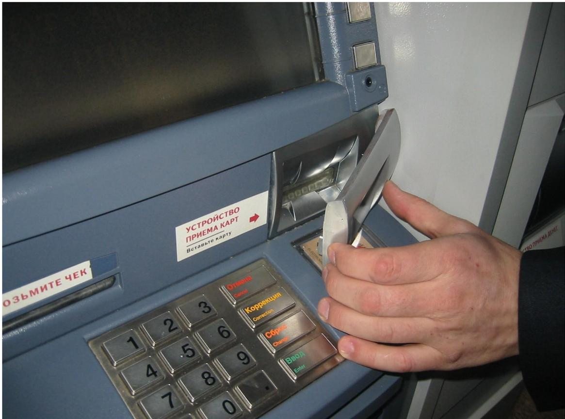
Рисунок 1 - Считывающее устройство в виде пластиковой накладки на кардридер.
